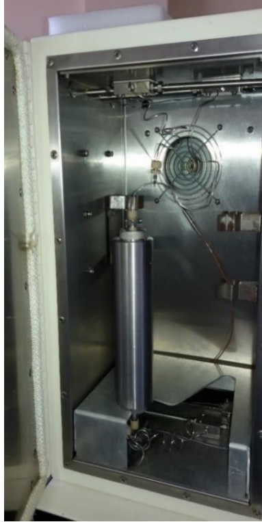
Figura 8: Interior do forno, coluna e dutos capilares da unidade de extração supercrítica.
